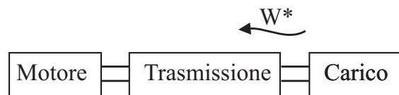
Figura 11.53: Schema di funzionamento di una macchina con flusso di potenza retrogrado
