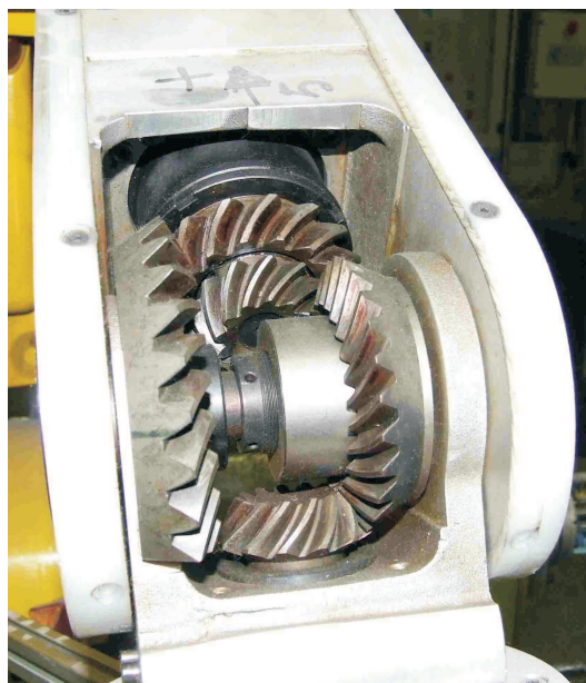
Figura H.56: Il polso del robot DOGHI con trasmissione ad alberi cavi, ingranaggio conici a denti elicoidali.
